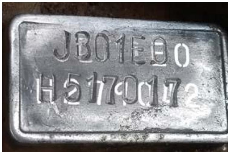
Ilustração 38: adulteração em motor de veículo (créditos: Núcleo de Identificação Veicular IC/POAL)
